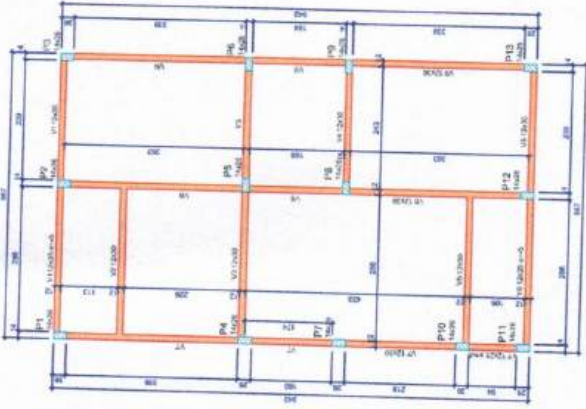
Forma do pavimento Nivel 0 Baldr (Nível -5) escala 1:50
