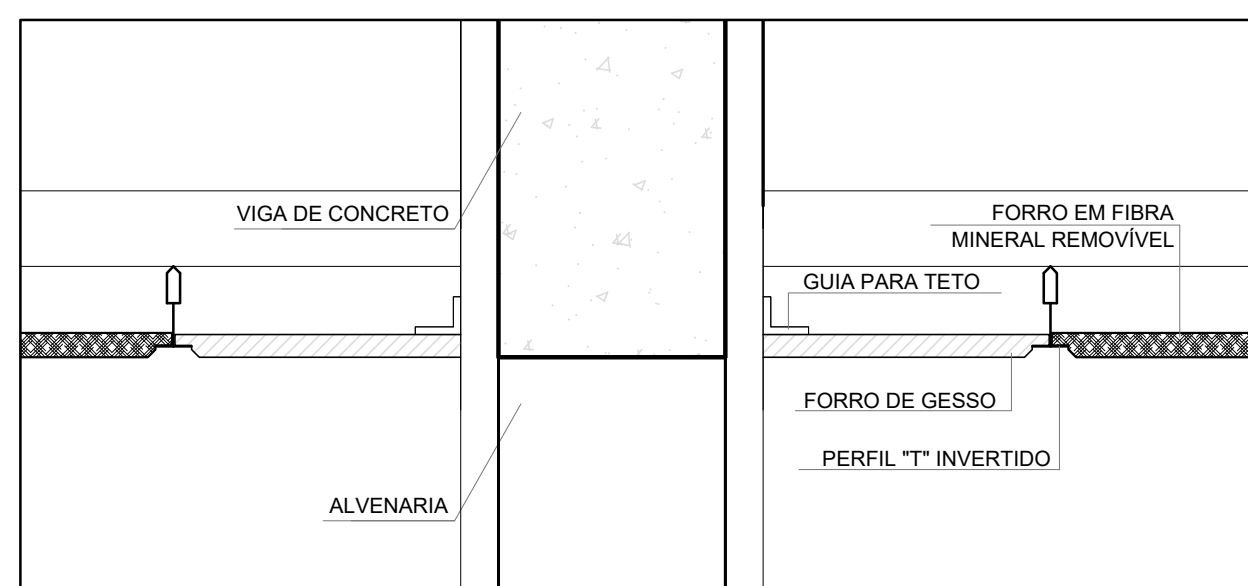
3 DETALHE 2: FORRO MINERAL E GESSO ESCALA 1/5
