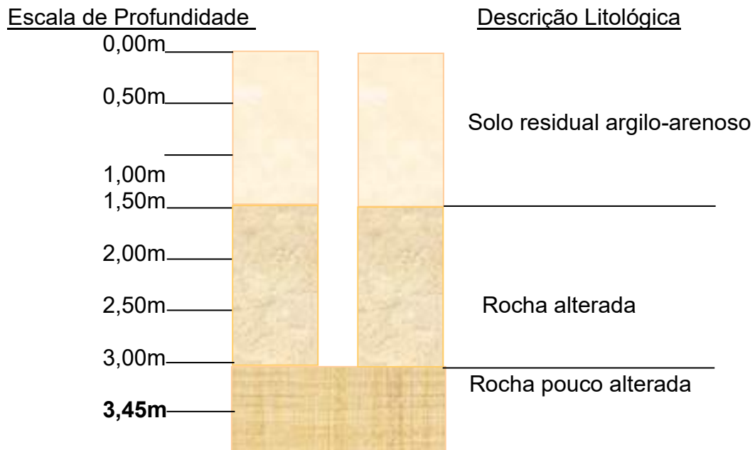
Fig. 3: Perfil Geológico da Sondagem S3 – 3,45m
