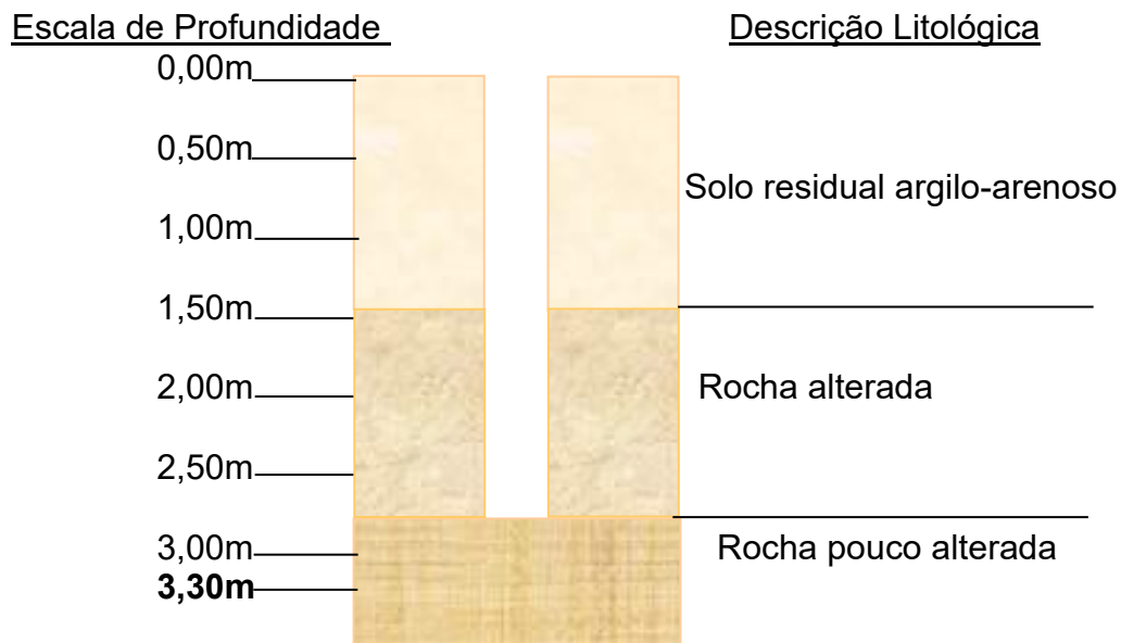
Fig. 3: Perfil Geológico da Sondagem S3 – 3,45m
