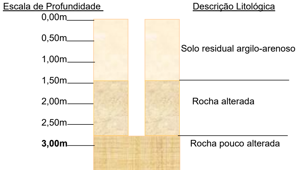
Fig. 5: Perfil Geológico da Sondagem S5 – 3,00m
