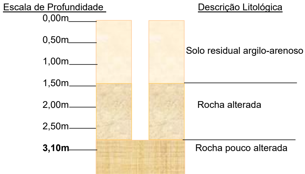
Fig. 6: Perfil Geológico da Sondagem S6 – 3,10m
