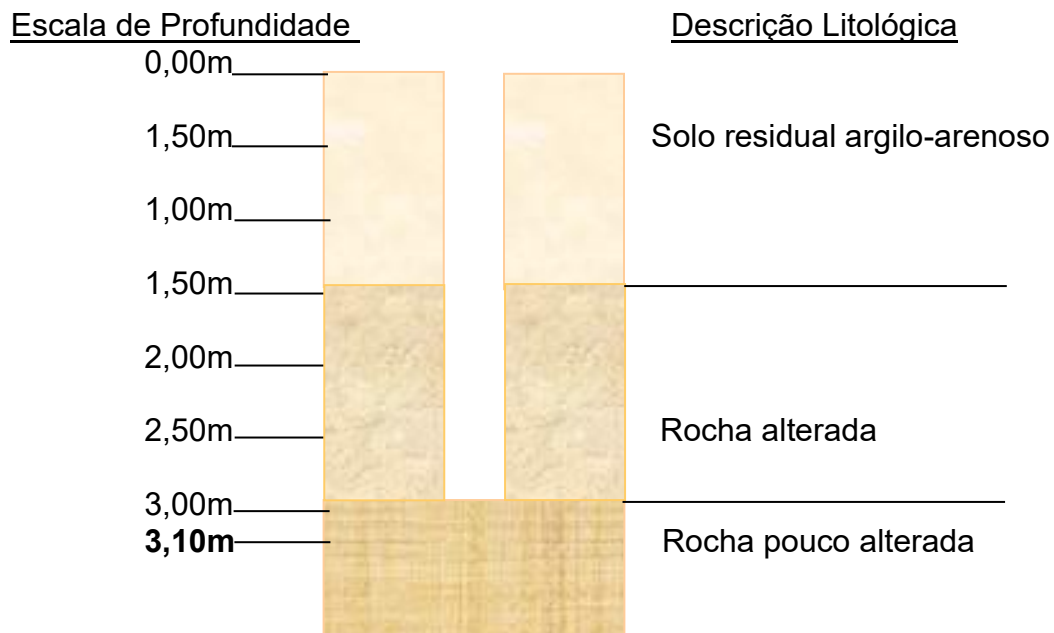
Fig. 1: Perfil Geológico da Sondagem S1 – 3,10m
