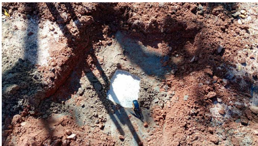
Figura 10 – Ensaio de infiltração 03.
