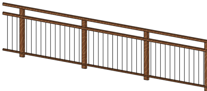
Figura 26 – Guarda-corpo com corrimão em madeira e aço.
