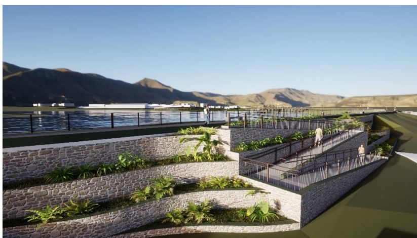
Figura 25 – Rampa de acesso com jardins em Gabião.
