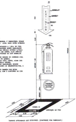
DETALHE DE FIXAÇÃO E SINALIZAÇÃO EXTINTOR EM PAREDE E/OU PILAR (DETALHE 01)
