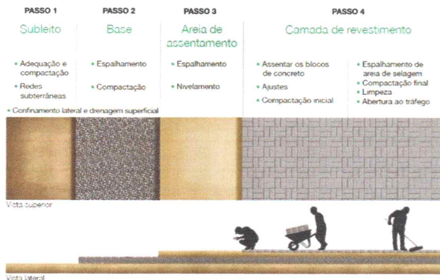
Figura 1: Etapas de piso intertravado de concreto.
