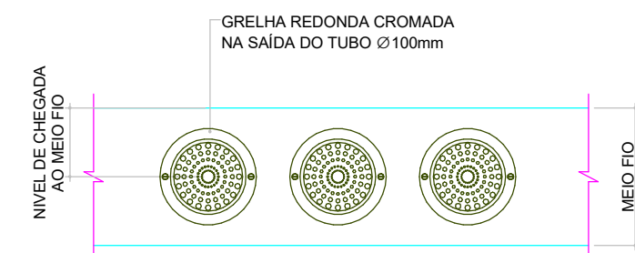
DETALHE-03 SAIDA DO TUBO PVC Ø100 NA SARJETA ESCALA:1/10
