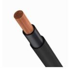
Condutor flexível de cobre nu, têmpera mole, encordoamento classe 5. Isolação de PVC/A 70°C - composto termoplástico extrudado à base de policloreto de vinila, com características especiais para não propagação e auto extinção do fogo.
