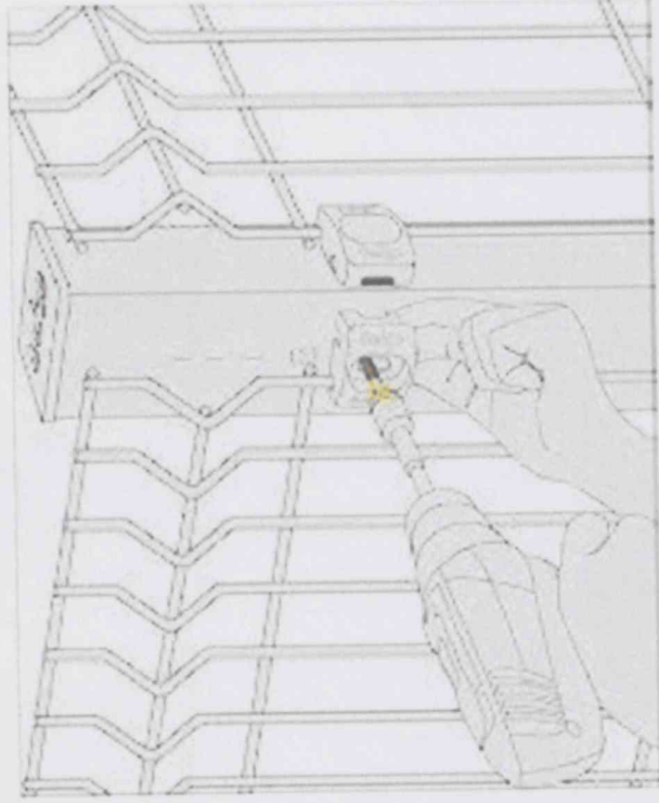
Detalhe de Fixação do Cerca ao Poste c/Parafusadeira
