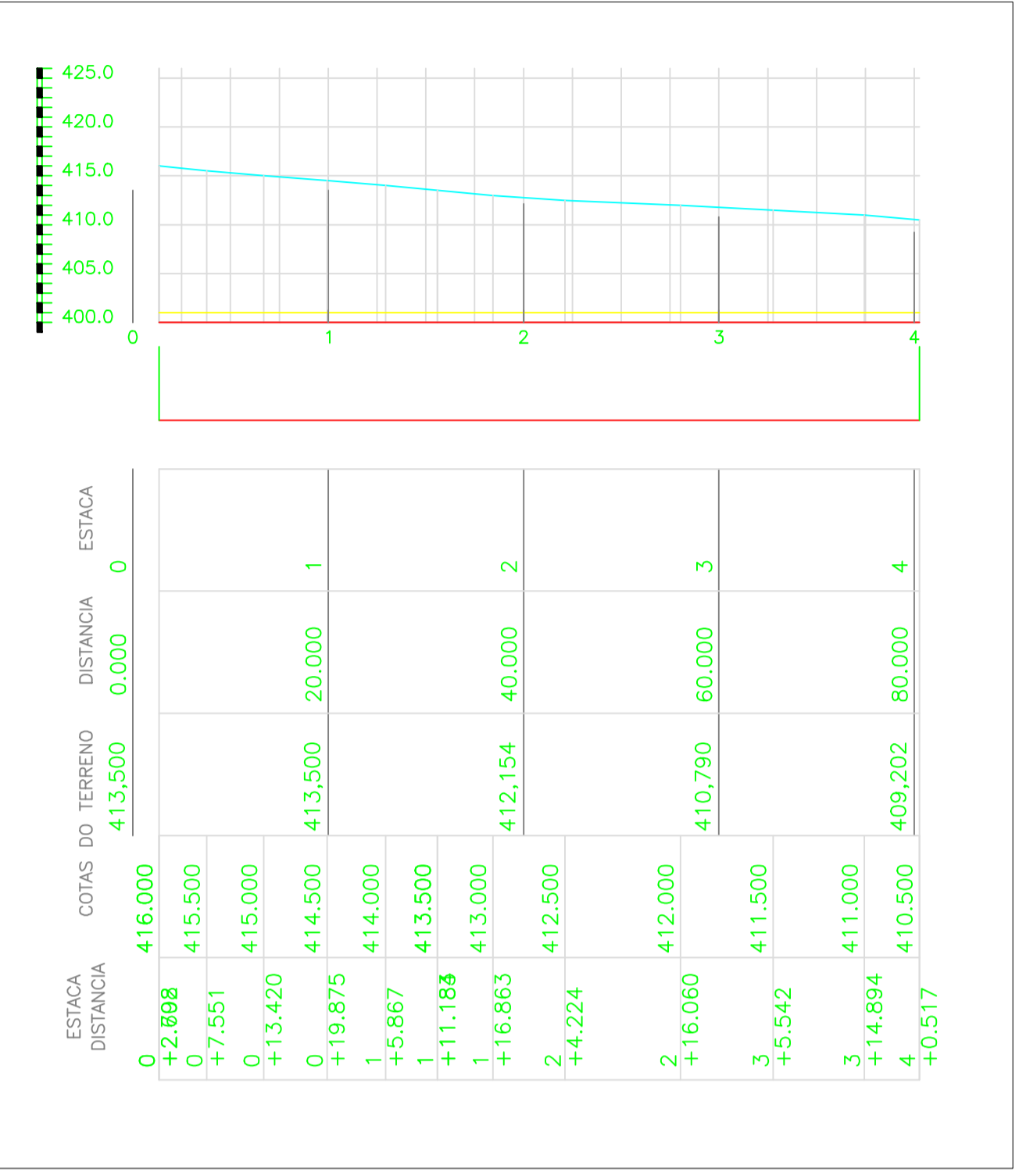
04 PERFIL LONGITUDINAL ESCALA 1:750
