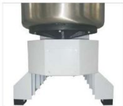
Túnel para facilitar a limpeza
