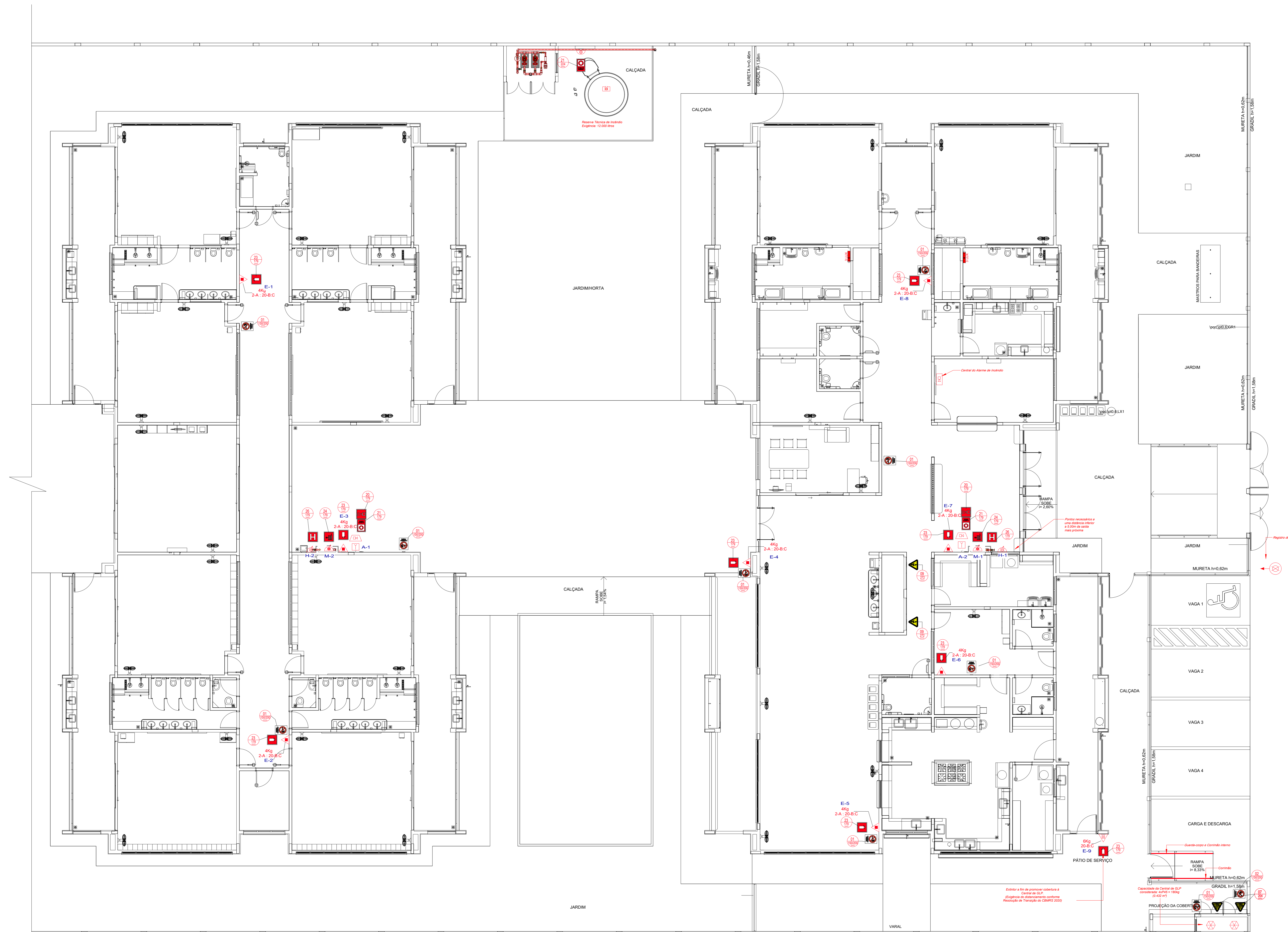
1 PLANTA BAIXA - EXTINTORES, ALARMES E HIDRANTES ESCALA 1/75
