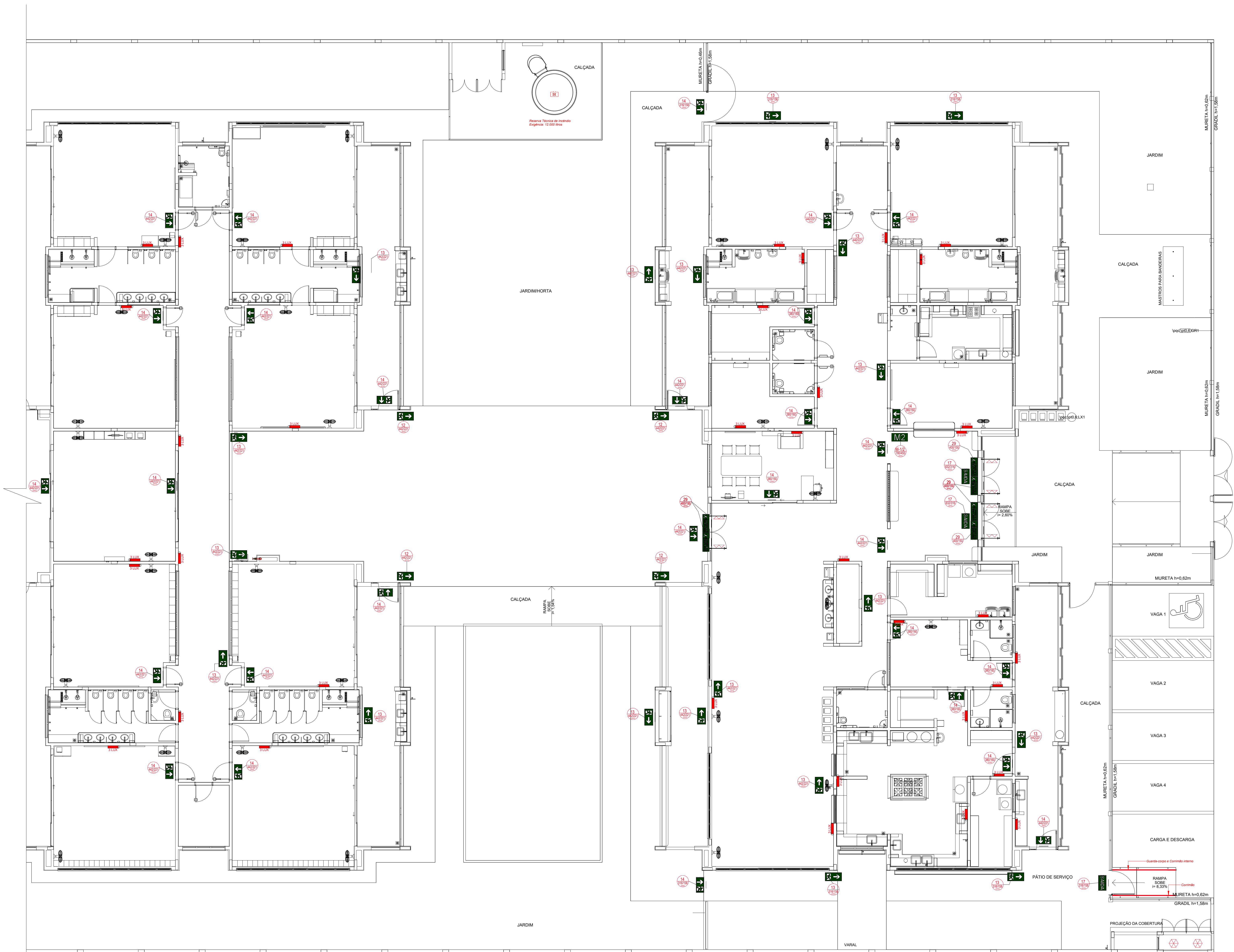
1 PLANTA BAIXA - SINALIZAÇÃO E ILUMINAÇÃO ESCALA 1/75
