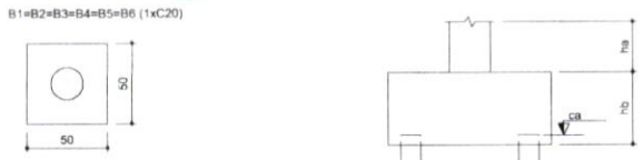
2 BLOCOS DE FUNDAÇÃO ESCALA: 1/25
