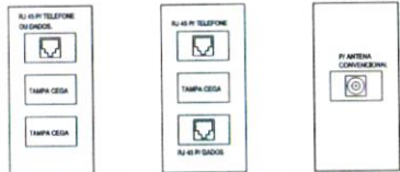
DETALHE 01 - CAIXA 10x20cm PONTO DE VOZ SEM ESCALA DETALHE 02 - CAIXA 10x20cm PONTO DE DADOS/VOZ SEM ESCALA DETALHE 03 - CAIXA 10x20cm PONTO ANTENA/TV SEM ESCALA USAR O QUE ESTIVER PREVISTO NO PONTO.
