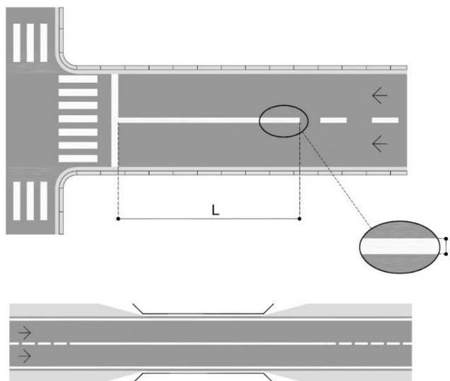
Linhas de Divisão de Fluxos de Mesmo Sentido: tracejadas, na cor branca, com largura ( $\ell$ ) de 0,10 m, em segmentos ( $e$ ) de 2,00 m de comprimento, espaçados ( $t$ ) de 2,00 m, vide figura que segue:
