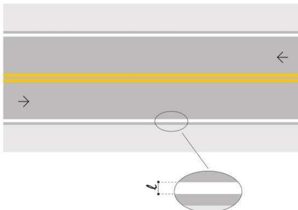
**Faixas de Retenção:** contínuas, na cor branca, com largura ( $\ell$ ) de 0,50 m. Nos cruzamentos deverão ser locadas a 1,00m da via a ser cruzada. O comprimento dela faixa será considerado a metade da largura da via para trechos de sentido duplo e a largura da via para trecho de sentido único.
