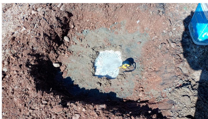
Figura 5 – Ensaio de infiltração 02.
