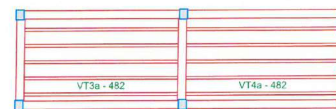
3 PLANTA VIGOTAS PRÉ MOLDADAS ESCALA: S/E
