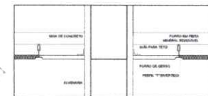
3 DETALHE 2: FORRO MINERAL E GESSO
