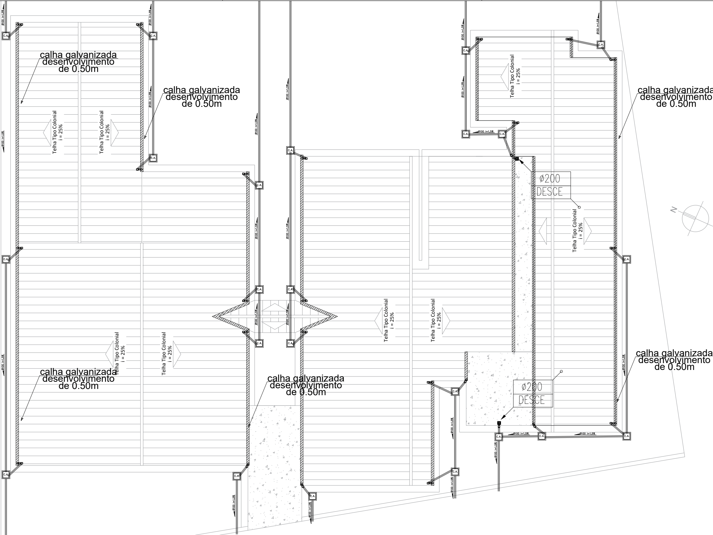
Calha galvanizada de desenvolvimento de 0.50m. Será utilizada nas junções de telhas.
