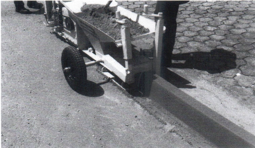
Figura 1 - Máquina extrusora de concreto para meio-fio
