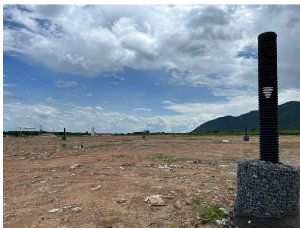
Figura 2. Chaminé utilizada para medição de gases.
