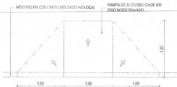
DETALHE - RAMPA ACESSIVEL ESC.: 1/50
