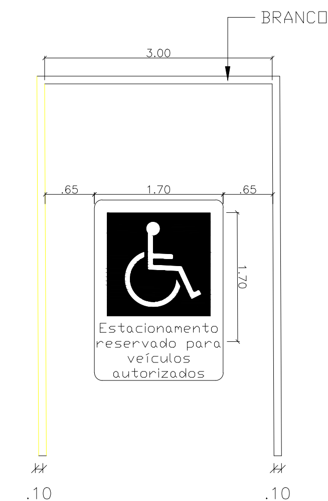
DETALHE DE SINALIZAÇÃO HORIZONTAL esc 1:50
