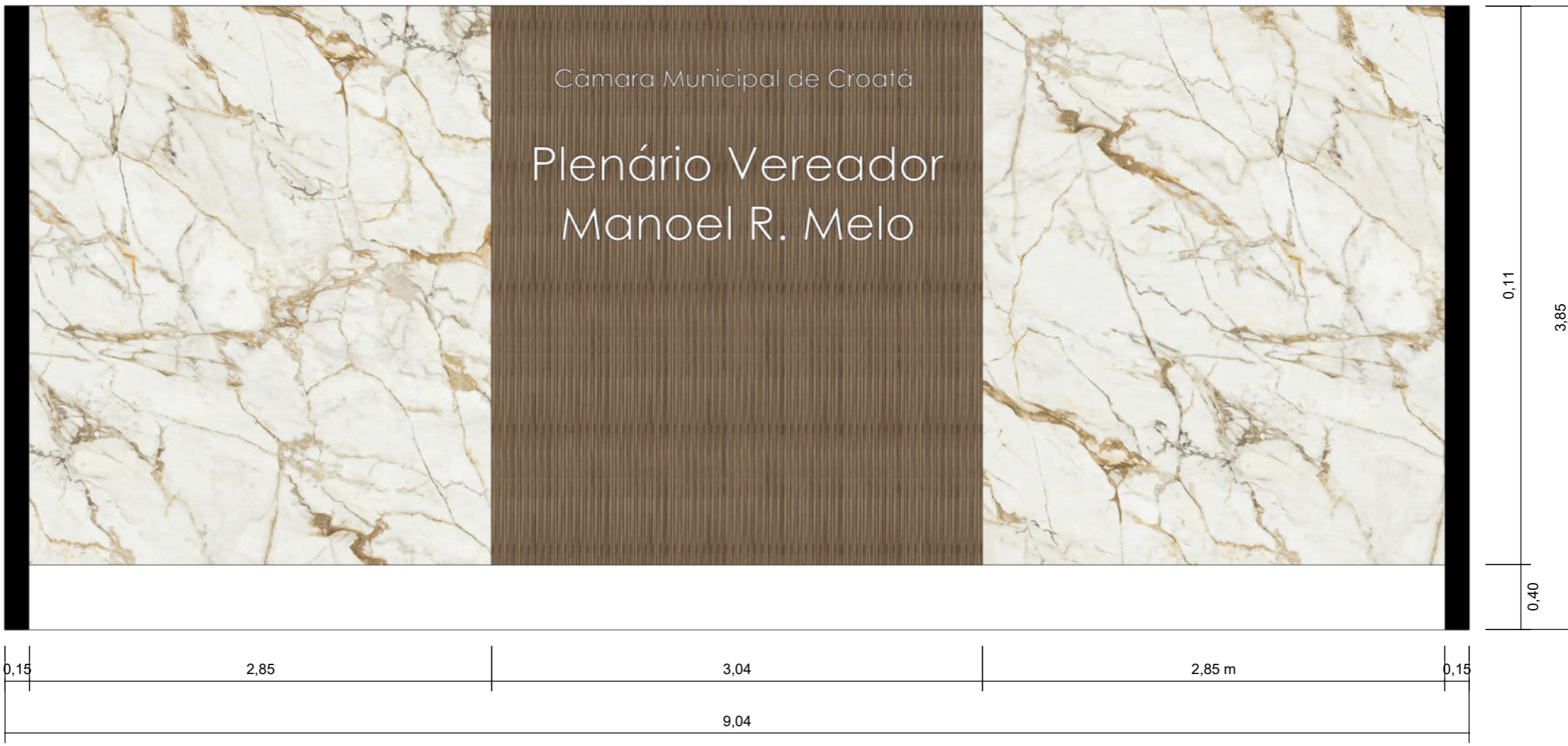
Detalhamento - Parede principal ESC - 1:32
