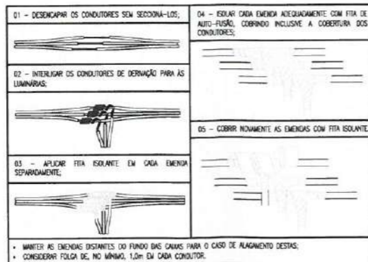
DETALHE-SUGESTÃO PARA EMENDAS escala: s/e
