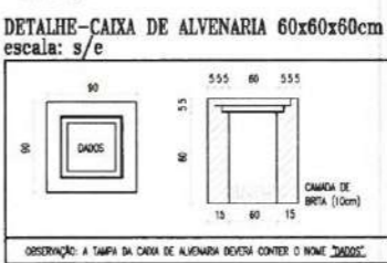
DETALHE-CAIXA DE ALVENARIA 60x60x60cm escala: s/e
