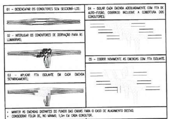
DETALHE-SUGESTÃO PARA EMENDAS escala: s/e
