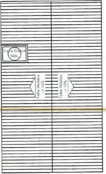
5 PLANTA DE COBERTURA - GALPÃO (3) SEC DE EDUCAÇÃO ESCALA 1/500
