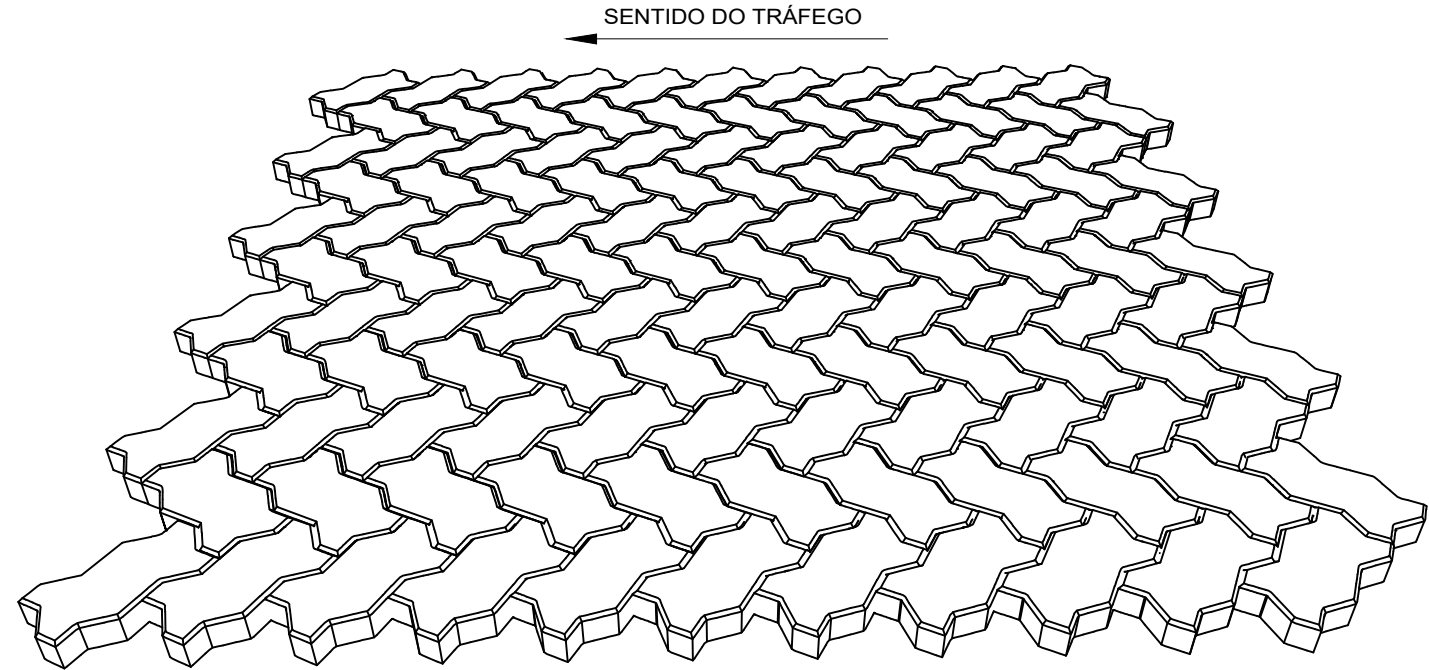
DETALHE INTERTRAVADO EM PERSPECTIVA
