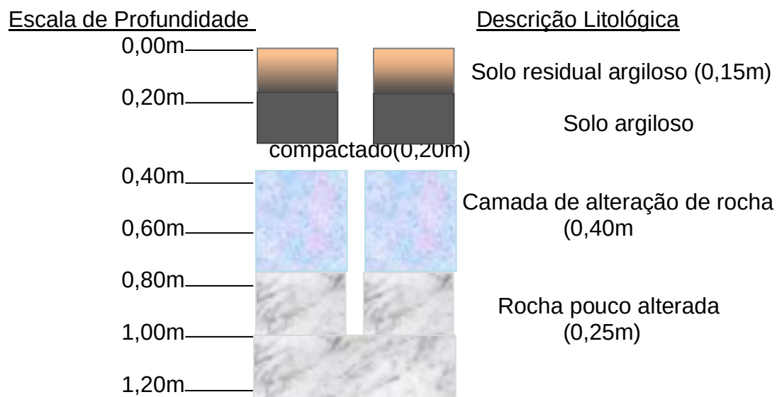
Fig. 02: Perfil Geológico esquemático em ST 02 com Profundidade Final 1,00m.
