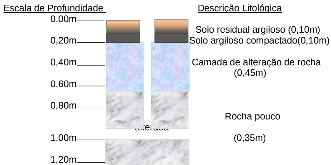
Fig. 10: Perfil Geológico esquemático em ST 10 com Profundidade Final 1,00m.
