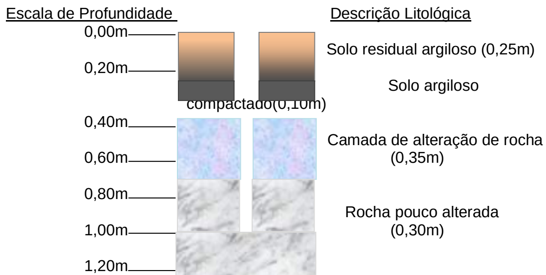
Fig. 15: Perfil Geológico esquemático em ST 15 com Profundidade Final 1,00m.
