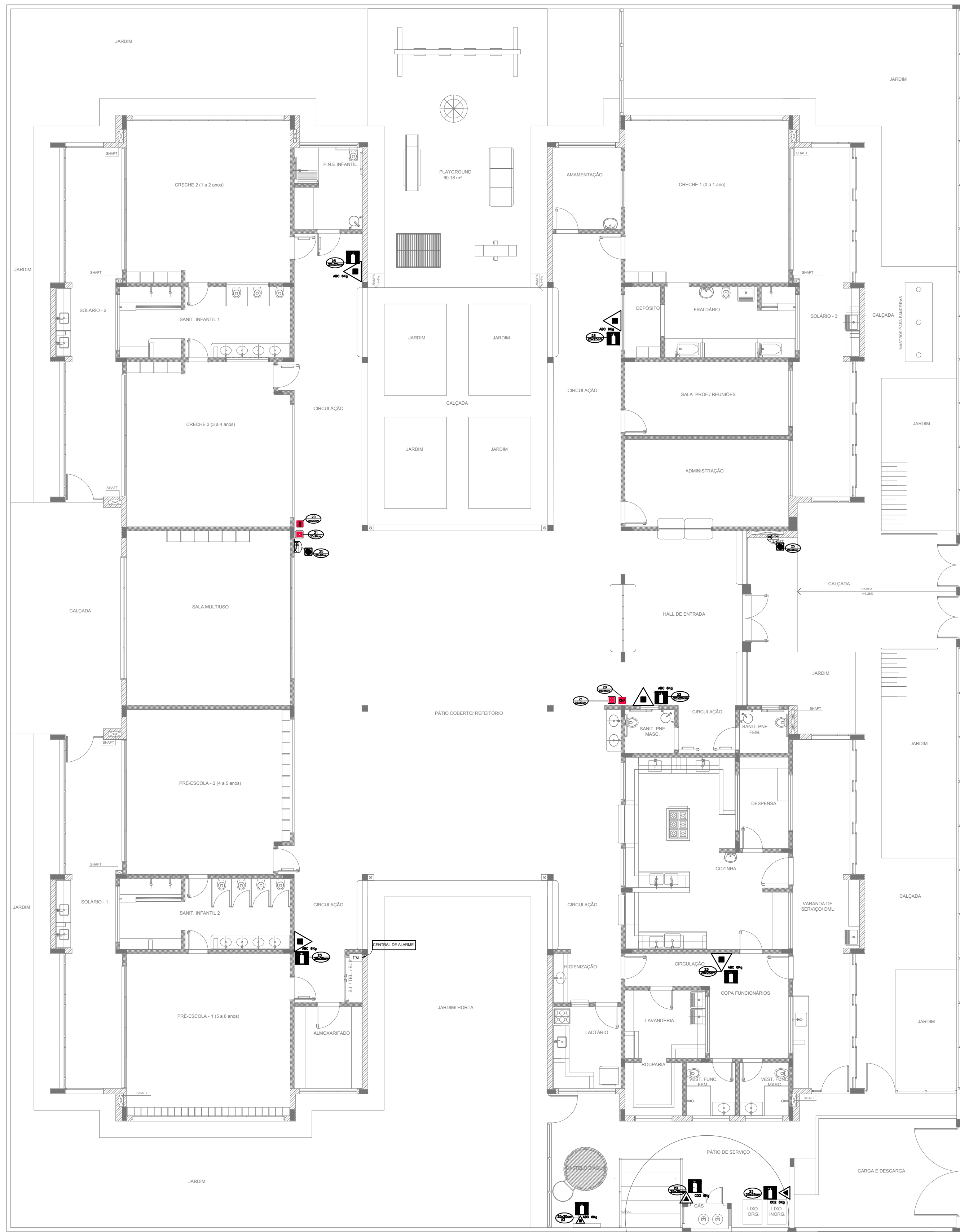
5 PLANTA BAIXA - LOCAÇÃO DOS EXTINTORES ESCALA 1/100
