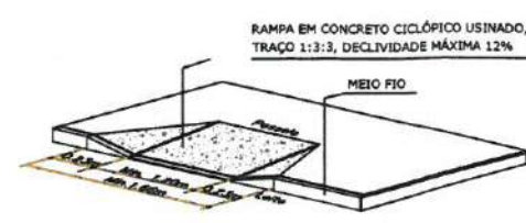
03 ISOMÉTRICO DA RAMPA DE ACESSIBILIDADE ESCALA 1:200
