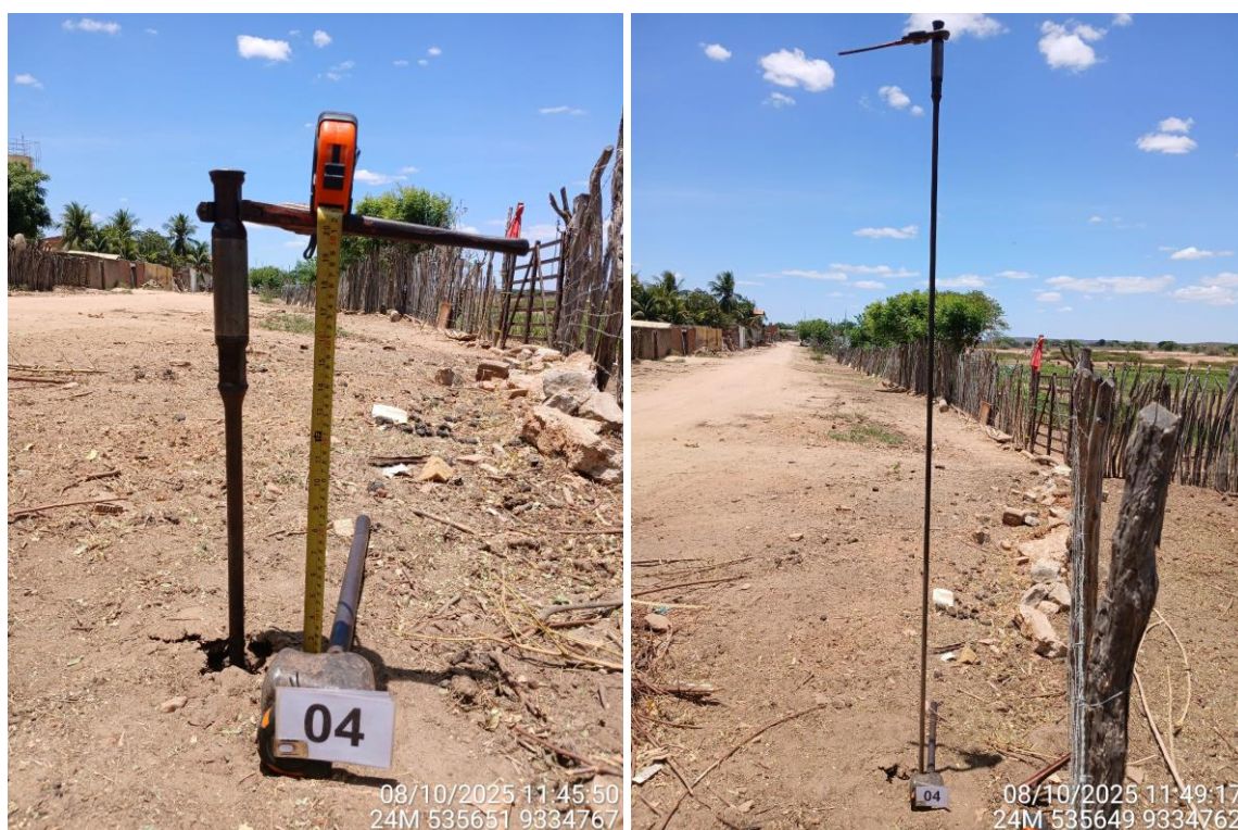
Foto 04 – Solo aluvionar argiloso compactado na base em ST 04. Rua Maria Marta em terreno natural.
