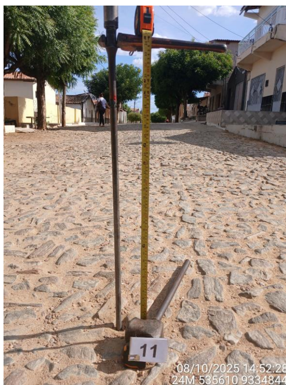
Foto 11 – Solo argiloso sobre rocha em ST 11.
