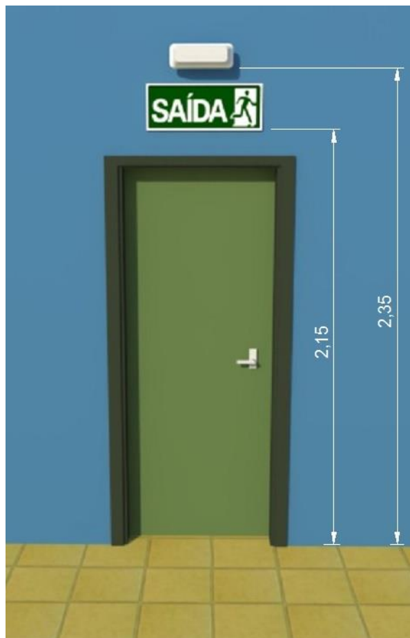
Sinalização de saída no sentido de fuga
