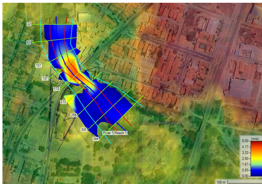
Figura 13. Mancha de inundação – Perfil de velocidade (HEC-RAS)
