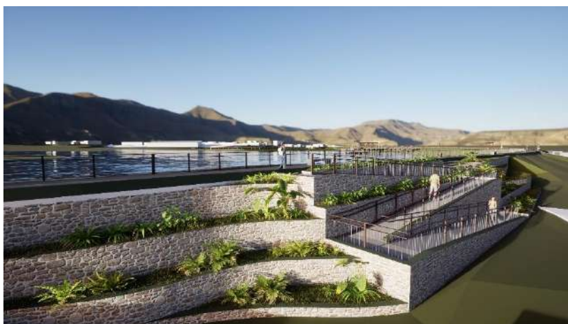
Figura 25 – Rampa de acesso com jardins em Gabião.
