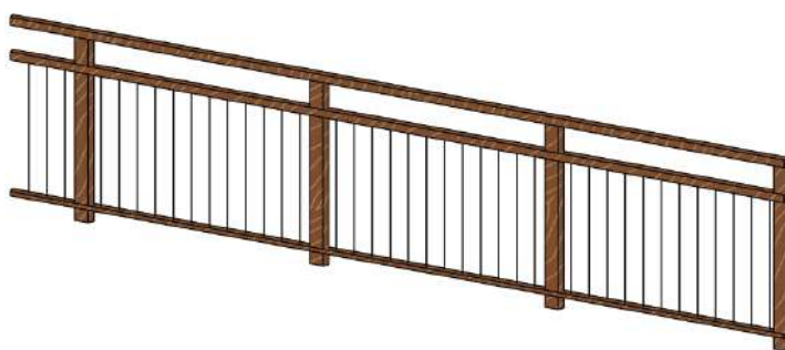
Figura 26 – Guarda-corpo com corrimão em madeira e aço.
