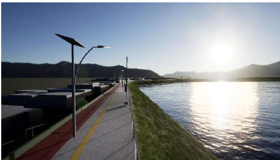
Figura 21 – Arranjo de uma pétala (luminárias de 30W) acoplado em poste flangeado cônico de 6m
