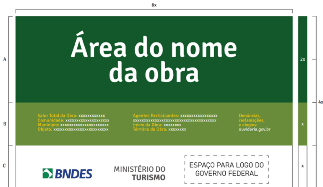
Figura 7 – Dimensionamento da placa de obra
